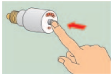
TULPPAMALLISEN AUTOMAATTISULAKKEEN ASETTAMINEN TOIMINTAKUNTOON
