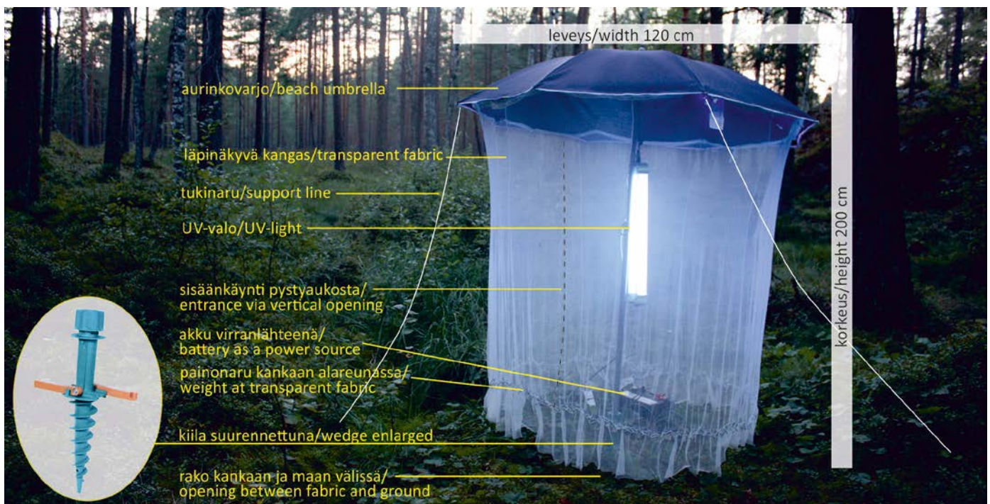
KUVA 1. Myrkytön hyönteispyydyks. Akulla toimiva UV-valo houkuttelee hyönteisiä, ne pääsevät sisään pyydyksen ja maan välissä olevasta raosta ja jäävät teltan sisälle. Hyönteiset koetaan menemällä pystysuuntaisesta kulkuaukosta pyydyksen sisälle ja ottamalla vain tarvittavat yksilöt talteen. Myrkytön hyönteispyydyks tarjoaa erinomaiset mahdollisuudet elävien yöperhosten valokuvaamiseen. Pyydyks tyhjennetään kääntämällä teltta ylösalaisin. Kuva: Kirkkonummi, Veikkola, 9.8.2014. | FIGURE 1. Non-poisonous insect tent. Battery operated UV-light attracts insects and they enter the tent via an opening between the tent and ground. Insects calm down and stay inside the trap and those can be collected by entering the tent via a vertical opening. The tent offers excellent conditions to photograph live specimens. The tent is emptied by turning it upside-down. Photo taken in Finland: Kirkkonummi, Veikkola, 9 August, 2014.
